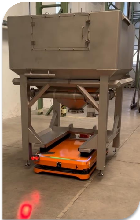
Mobilní robotická platforma s nosností 3 tuny.
