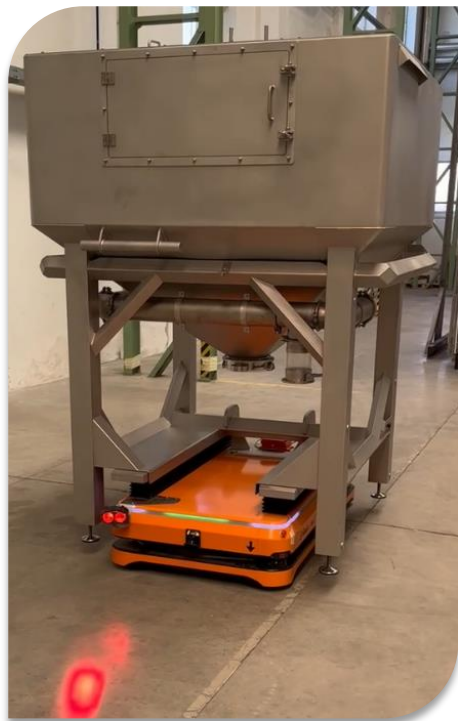
Mobilní robotická platforma s nosností 3 tuny.
